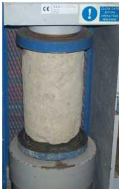
**Foto 3.5** Probeta lista para ensayo a compresión simple
