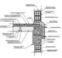
EMBUDOS DE LA LOSA UTILIZADOS COMO SALIDA DE DESAGUE PLUVIAL
