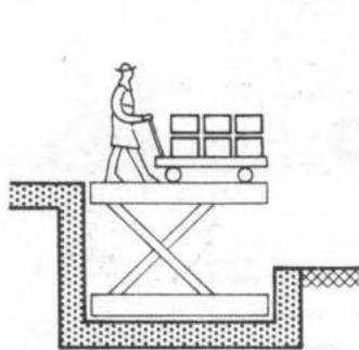
7 Plataforma de tijeras de accionamiento hidráulico para compensar la diferencia de nivel entre el muelle de carga y el camión
