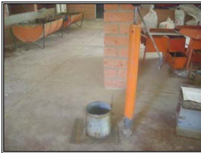
Fig. 4.7. Molde junto al martillo de 10 lb para realizar la compactación.
