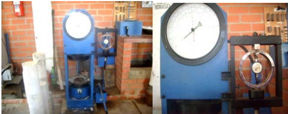
Fig. 4.1 Prensa hidráulica, a la derecha lector de 2000 KN y anillo dinamométrico de 5000 kg. de capacidad.
