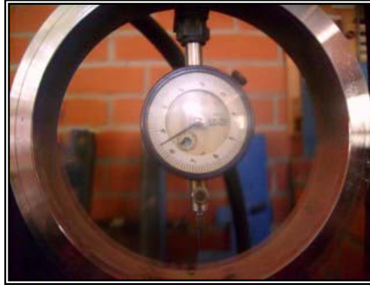
Fig. 4.5. Anillo dinamométrico con el que se lectura la capacidad de carga
