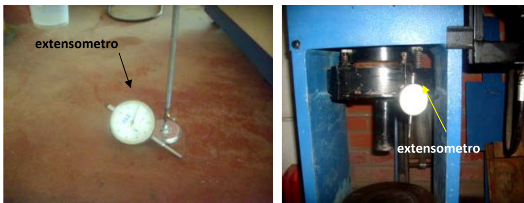
Fig.4.3. Instalación del extensómetro para medir el asentamiento del suelo
