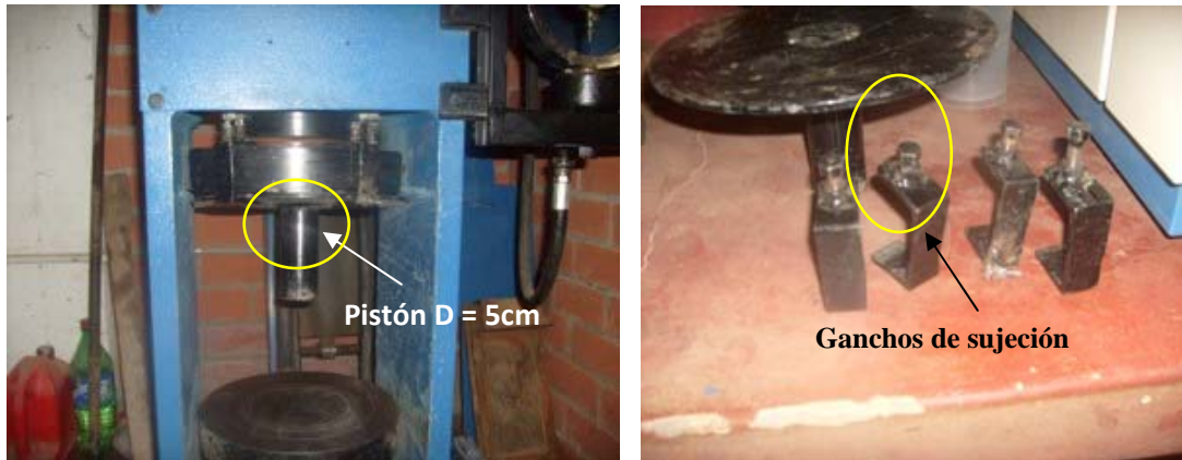
Fig. 4.2. Instalación del pistón a la plataforma de la prensa hidráulica
