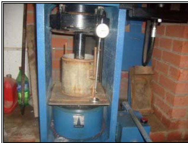
Fig. 4.6. Aplicación de fuerza sobre la muestra
