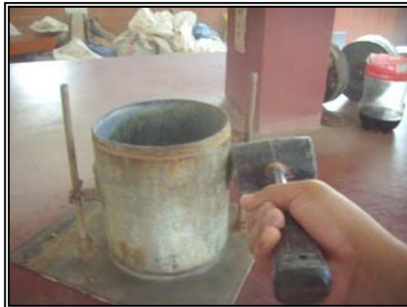
Fig. 4.10. Aplicación de carga dinámica (método vibratorio)
