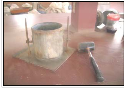
Fig. 4.9. Molde estandarizado para la aplicación de carga dinámica.
