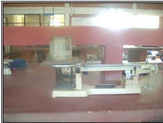
Fig. 4.8. Determinación del peso de la muestra con el molde después de haberse aplicado carga en la misma.
