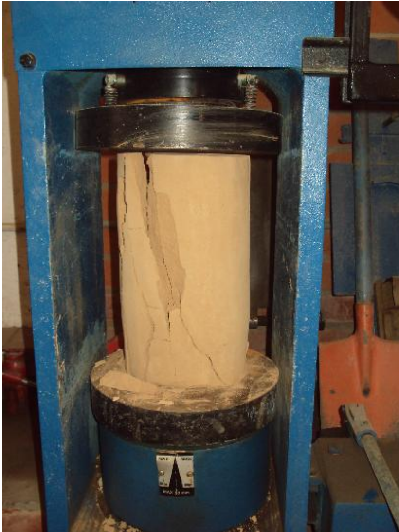
Foto 3.8 Otra de las probetas que también fue sometida a compresión
