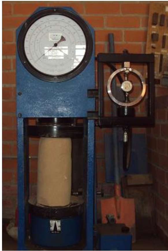
Foto 3.7 Probeta lista para ensayo a compresión simple
