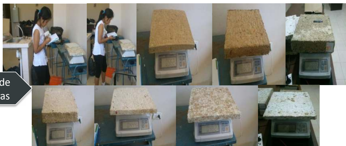
Esquema 3.6. Pesaje de muestras en Laboratorio de Arquitectura. Fuente.
