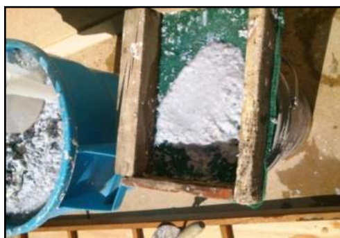
Fig. 3.17. Pulpa de papel saturado. Fuente autor.
