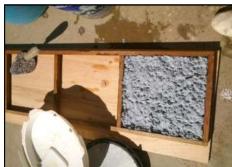
Fig. 3.18. Masa de papel/espesor 2cm. Fuente autor.
