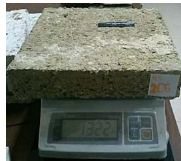
Fig. 4.10. Peso del Panel 2C6 . Fuente autor.
