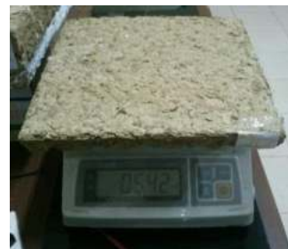
Fig. 4.4. Peso del Panel 2C2 . Fuente autor.
