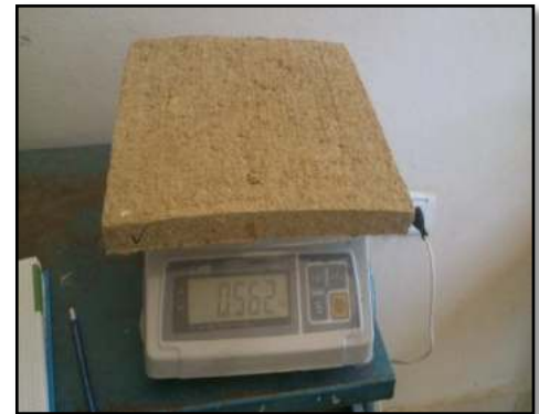
Fig. 4.2. Peso del Panel 1C2 . Fuente autor.
