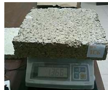
Fig. 4.8. Peso del Panel 1C6 . Fuente autor.
