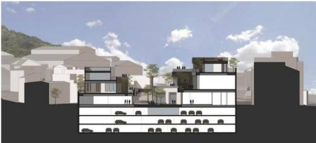
La Estructura del edificio está considerada en H°A° tradicional, planteando en Subsuelos losas sin vigas con capiteles. En los pisos superiores se consideró trabajar con losas y vigas tradicionales debido a que las luces a salvar no son de dimensiones excesivas y no hay restricciones ni limitantes de alturas. Podría considerarse por un tema de velocidad de construcción la inclusión de pilares y vigas metálicas, no hay aspectos que lo impidan.
