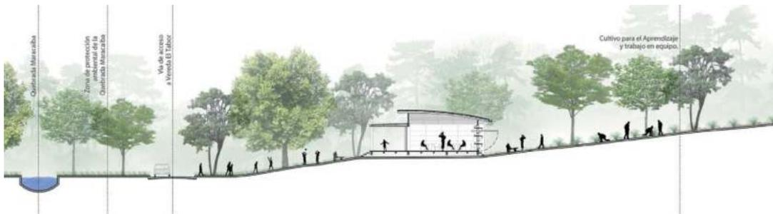
*Corte general. La planta se levanta del piso para adaptarse al terreno inclinado y como protección en caso de inundación.*
