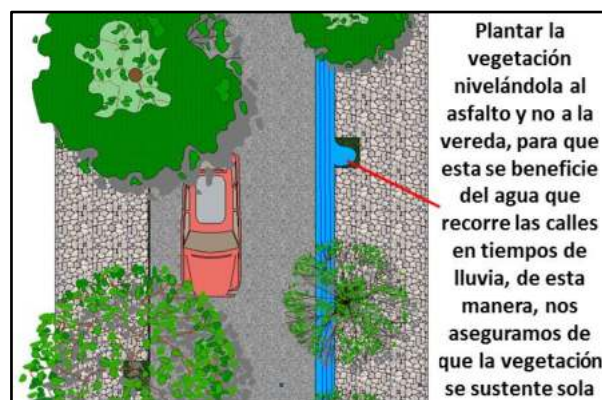
Figura 65 forma de canalizar agua de lluvia Fuente: elaboración propia
