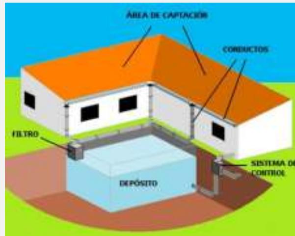
**Elementos de un sistema de distribución de aguas pluviales**
