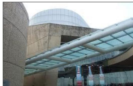
Se puede apreciar la disposición de la estructura de placas de hormigón las cuales llegan a formar parte de la cubierta, los paños de vidrio generan iluminación y ventilación natural con marcos metálicos adosados a las estructuras de hormigón, los elementos vidriados que generan iluminación a los ambientes.
