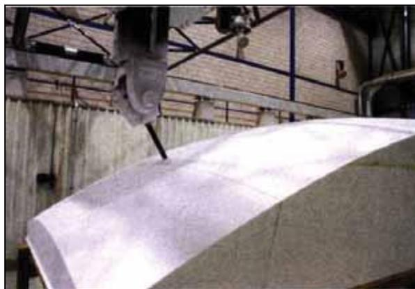
Fig. 2.30. Encofrado EPS. Fuente internet.
