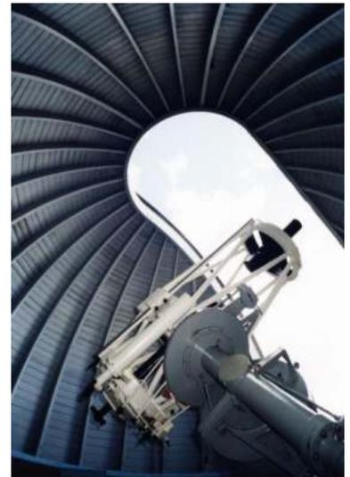
**Telescopio reflector AZT 7,** Diámetro del espejo primario = 20 cm. Distancia focal = 500 cm. Pantalla para observación solar.
