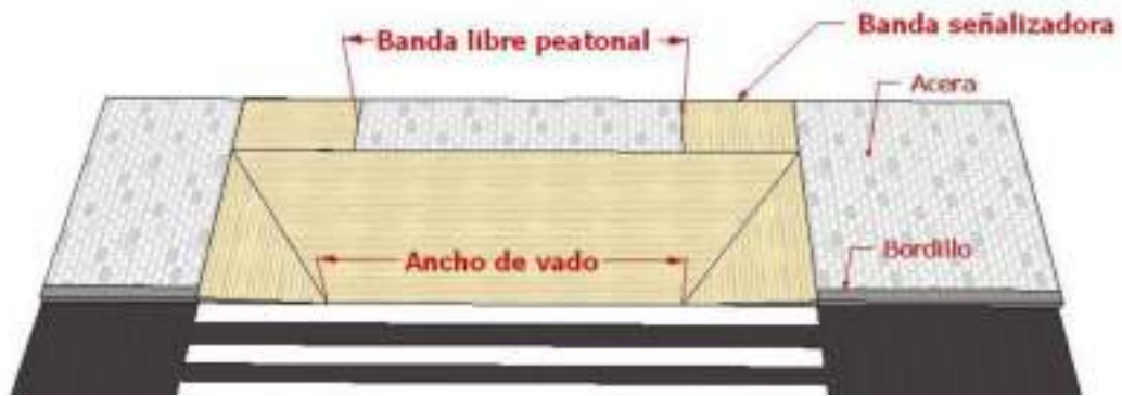
Vado tres rampas con bandas señalizadores laterales.
