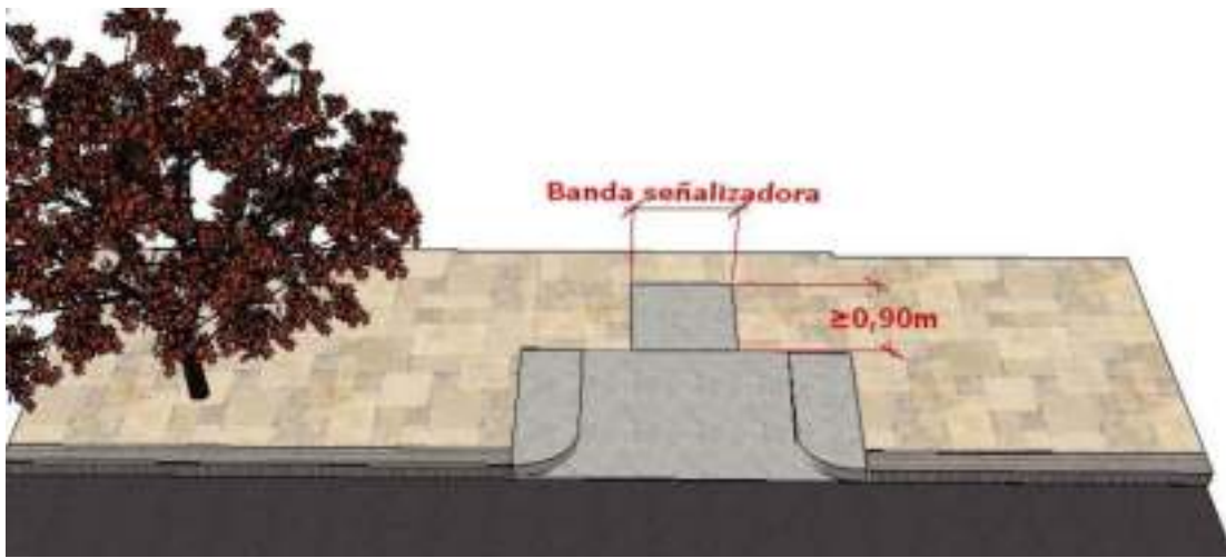
Vado de una rampa.
