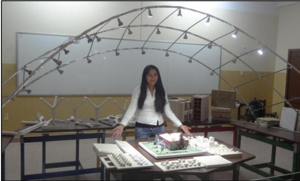
Figura 88 **Heliodón y maquetas utilizadas** Fuente: elaboración propia
