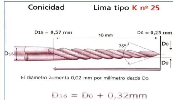
Fig. N° 12 Conicidad de los instrumentos endodónticos estandarizados.
