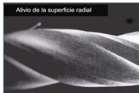
Fig. N° 14 Alivio de la superficie radial.
