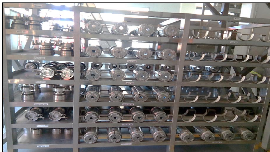
Figura 4.40 Estante de moldes del equipo de soplado.
