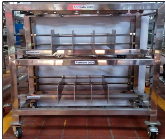
Figura 4.39 Estante de manejos del equipo túnel termocontraíble.
