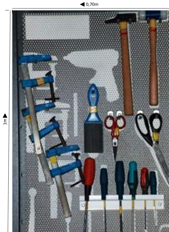
Figura 5-11. Tablero de ubicación de herramientas
