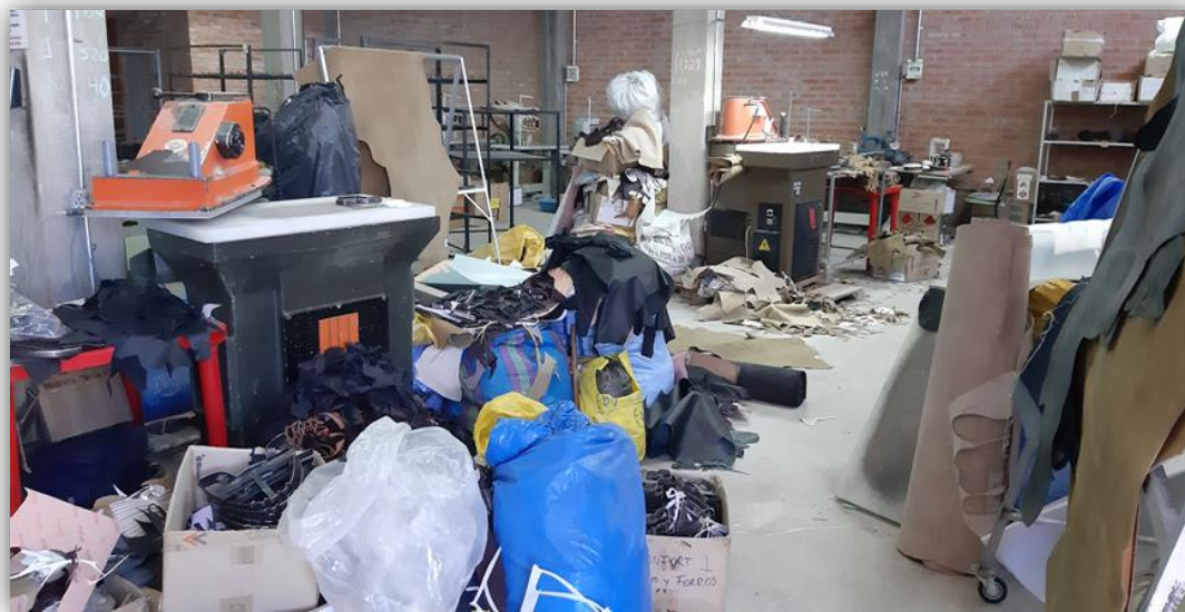
Fig. 4-2 Pasillos obstruidos por los residuos y materiales
