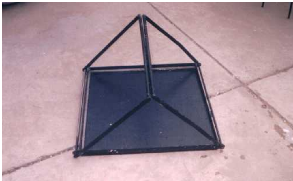
Fotografía N° 44 Preparado del molde metálico antes de colocar la pulpa.
