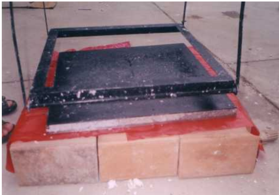
Fotografía N° 49 Retirado de la base del molde
