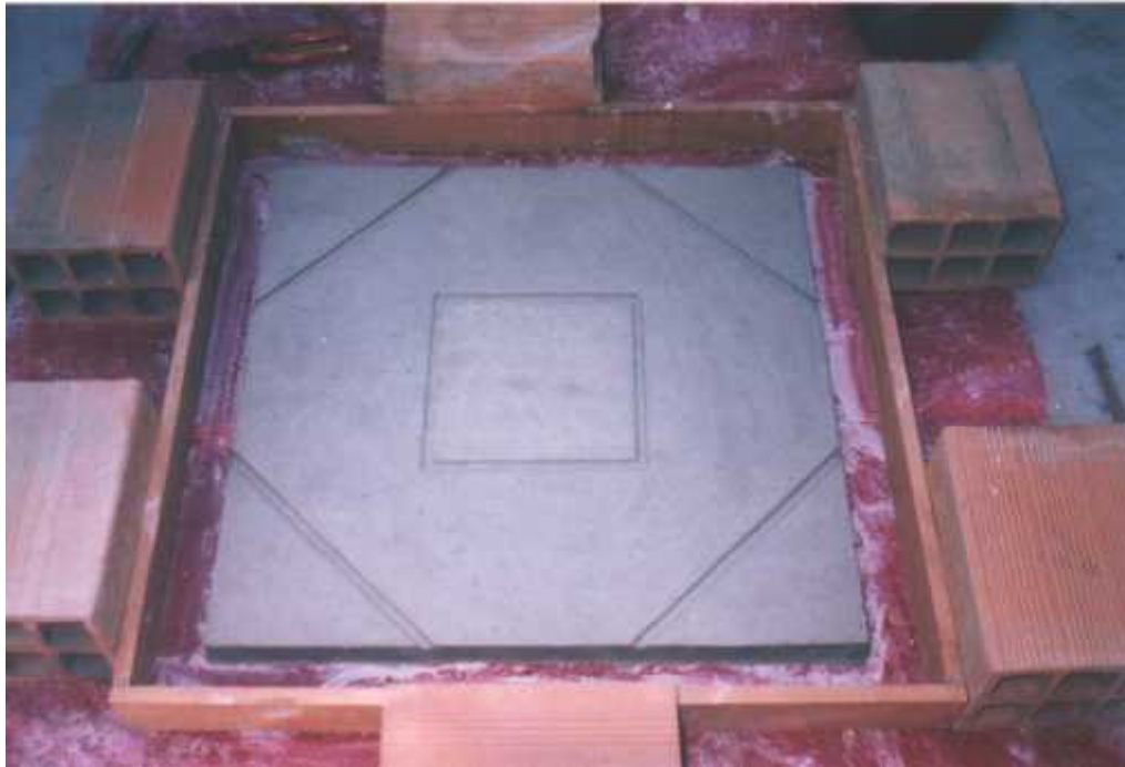
Fotografía N° 11 Vaciado de yeso cemento encima del positivo de arcilla.
