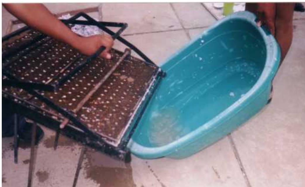
Fotografía N° 47 Evacuación del agua de la pulpa mediante presión.
