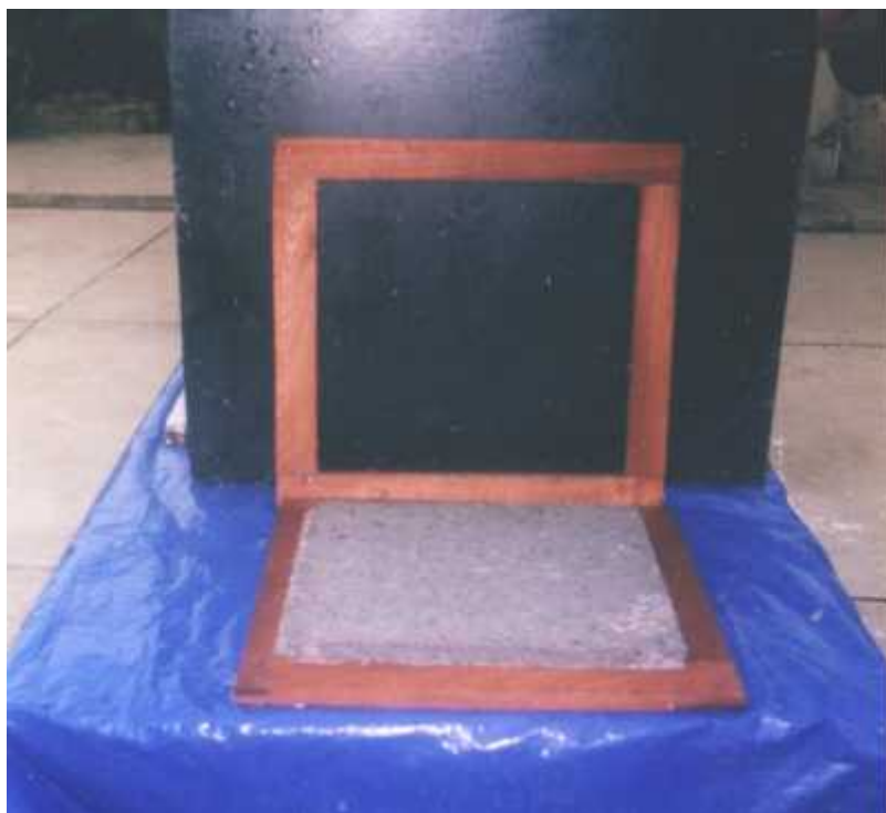
Fotografía N° 42 Proceso de secado del plaqueta de cielo falso o raso
