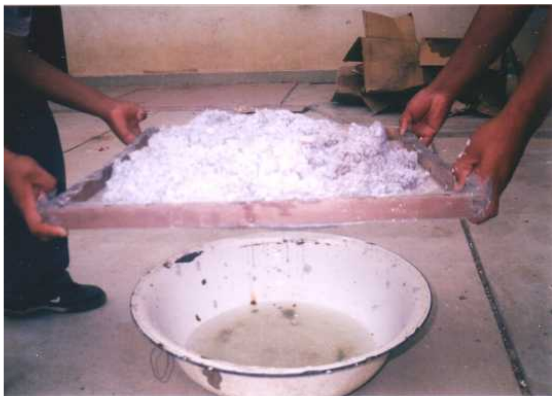
Fotografía N° 30 Recuperación del agua de pulpa de papel mediante gravedad.
