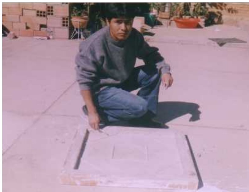
Fotografía N° 14 Molde yeso cemento terminado
