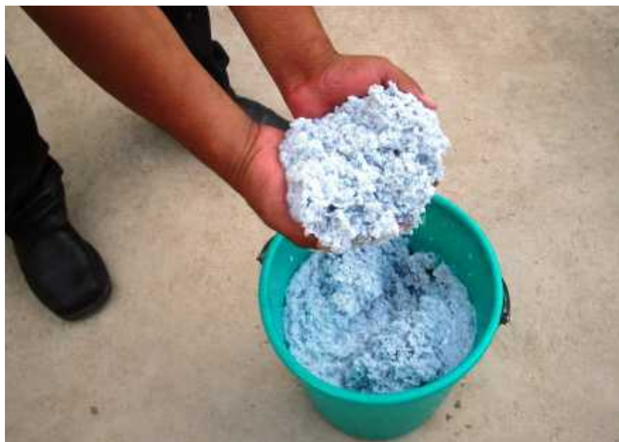
Fotografía N° 24 Pulpa después de agitación mecánica.
