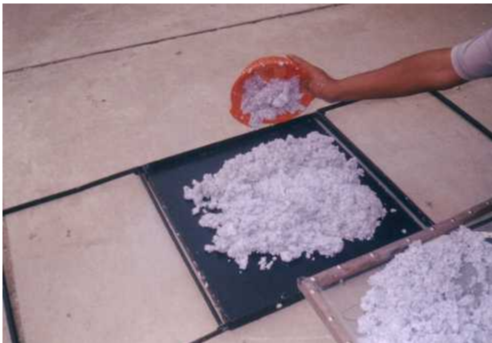
Fotografía N° 46 Ejerciendo presión con el molde a la pulpa de papel.
