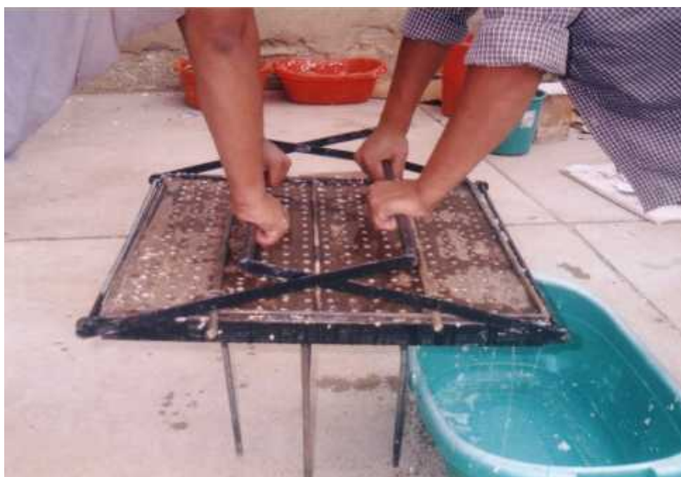
Fotografía N° 46 Ejerciendo presión con el molde a la pulpa de papel.
