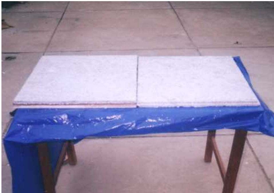
Fotografía N° 50 Secado de las plaquetas de cielo falso o raso
