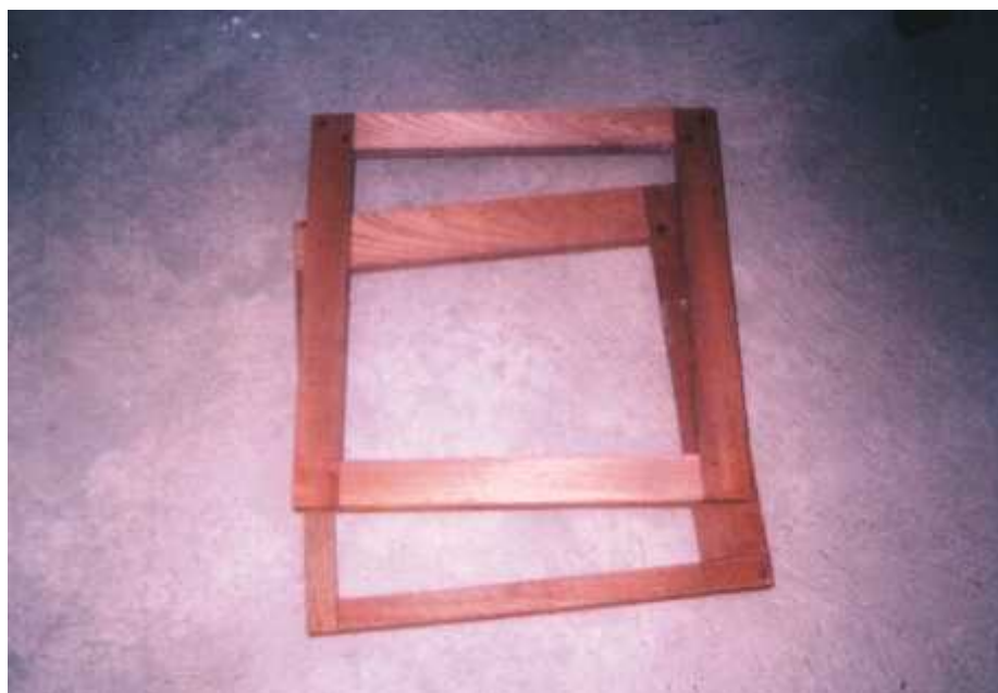
Fotografía N° 16 Culminación del molde real de madera terminado
