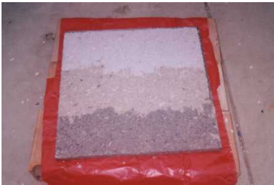
Fotografía N° 51 Placa de cielo falso o raso (pulpas en barras)
