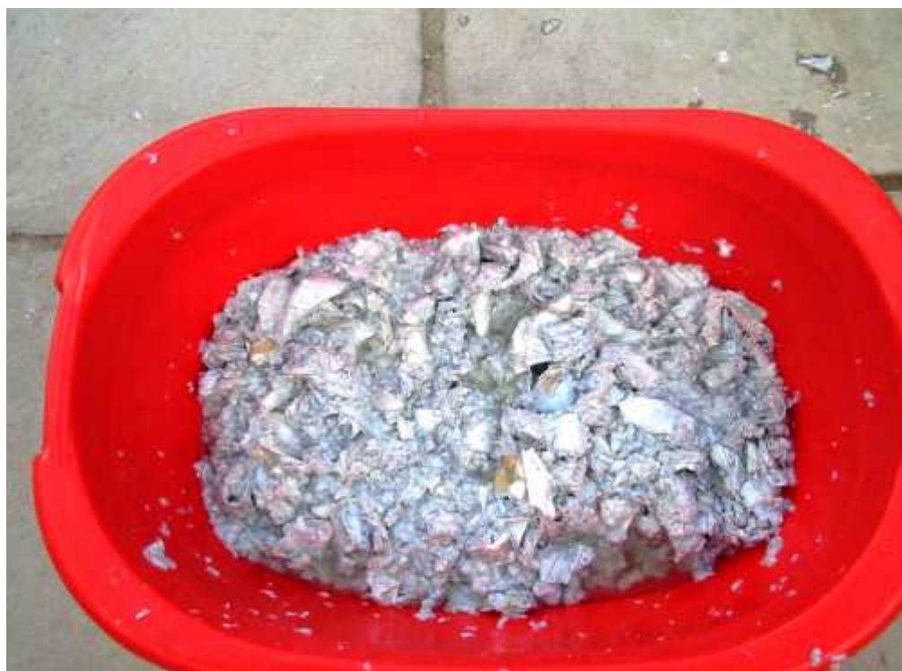
Fotografía N° 25 Pulpa rustica para la fabricación de ladrillos
