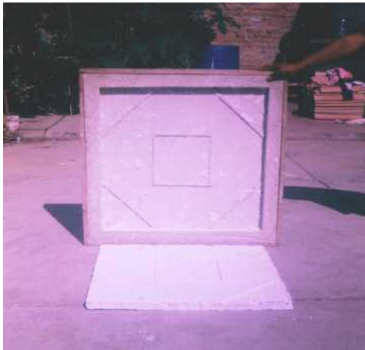
Fotografía N° 37 Secado de la plaqueta de cielo falso o raso.
