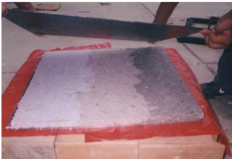
Fotografía N° 49 Retirado de la base del molde
