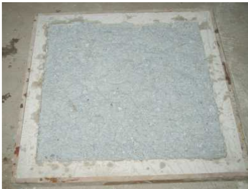
Fotografía N° 34 Vaciado de la segunda capa de pulpa de papel
