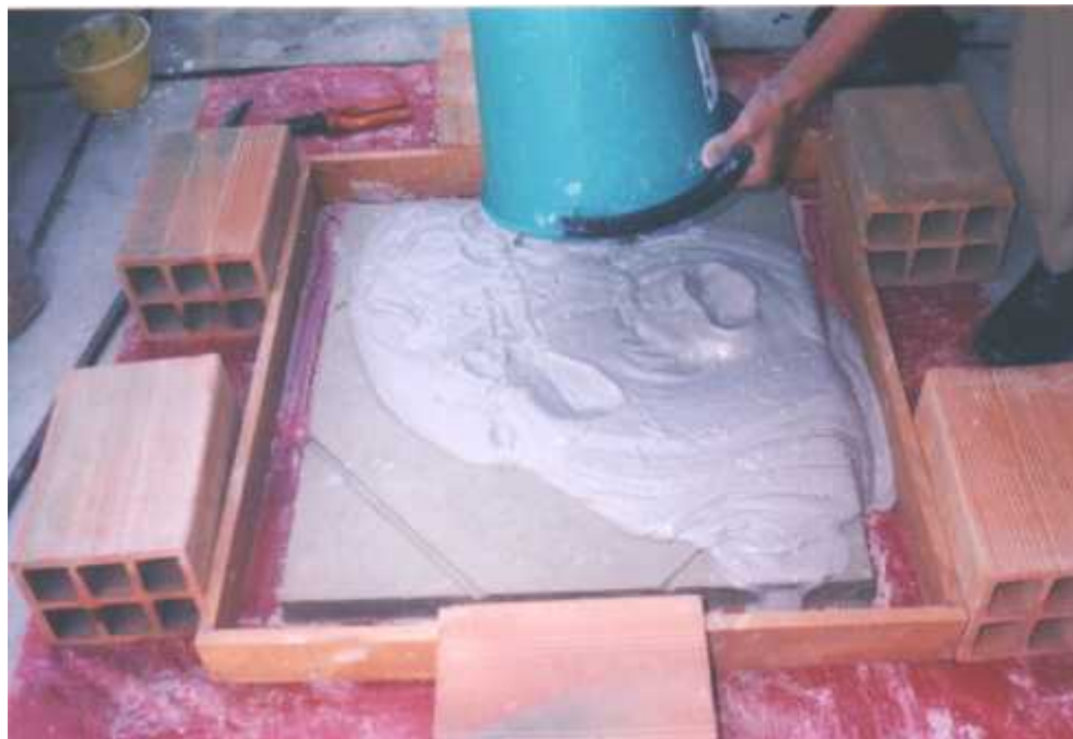
Fotografía N° 11 Vaciado de yeso cemento encima del positivo de arcilla.
