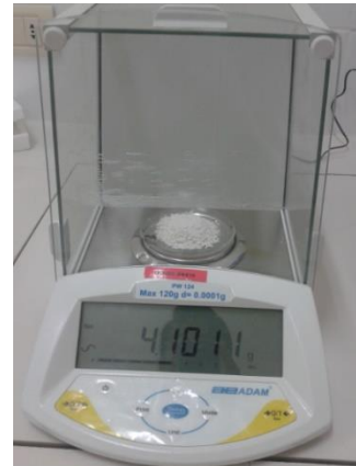
Figura 2-7: Pesaje de las almendras trituradas
