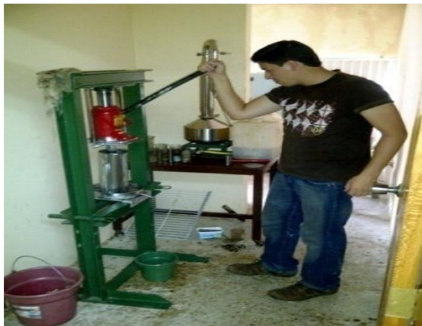
Figura 1-2: Proceso de extracción mediante prensado hidráulico
