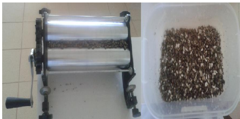
Figura 2-5: Trituración de las semillas de ricino
