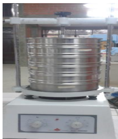
Figura 2-6: Tamizado de las semillas de ricino
