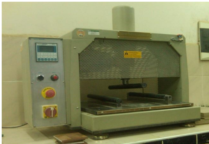
Foto N° 20 Máquina de ruptura que se utiliza en el laboratorio de cerámica Coboce
