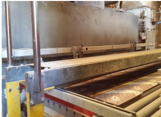
Foto N° 12 Ingreso de las piezas al horno
