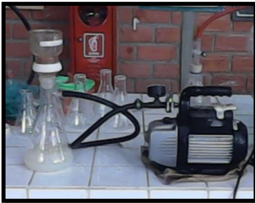
Figura 3-18 Equipo de filtrado al vacío.
