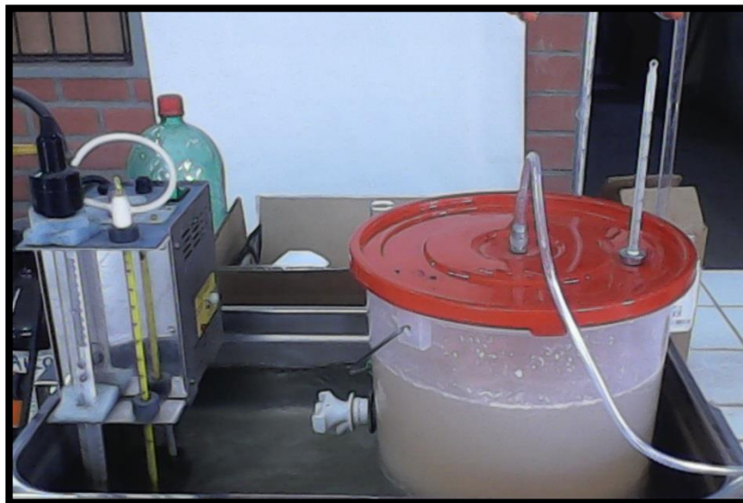
Figura 3-17 Reactor de fermentación de 10 litros
