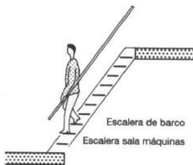
4 Escaleras a la molinera con barandilla
