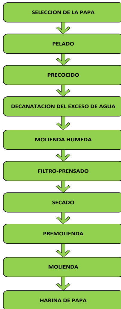
Figura 1.1: Diagrama de bloques del proceso de elaboración de harina de papa a partir de papa precocida
