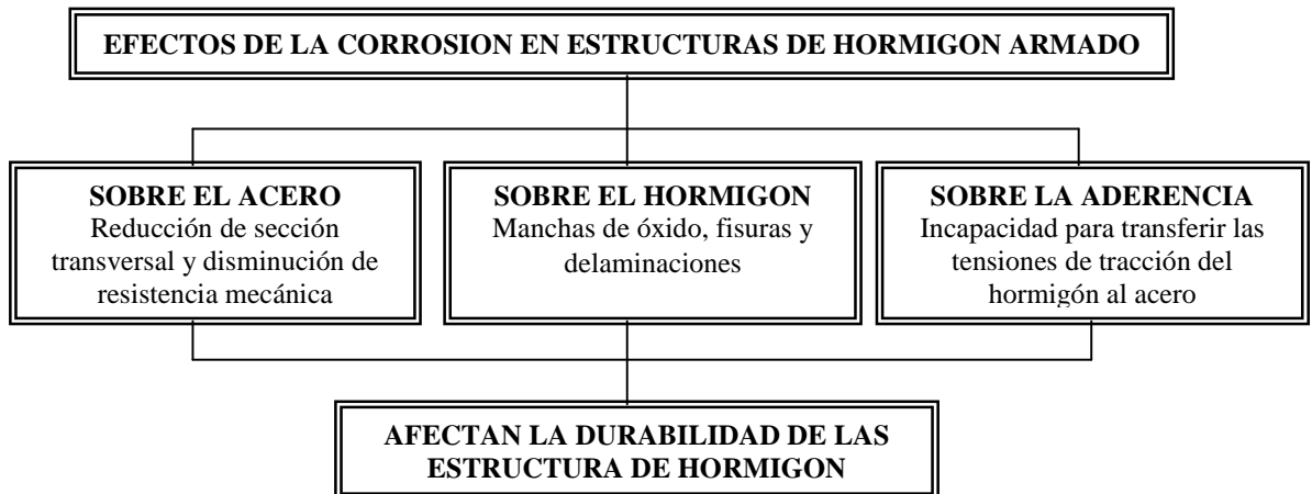
Figura 4.16: Efectos de la corrosión en el H º A. Fuente: Biblioteca virtual Miguel de Cervantes.
