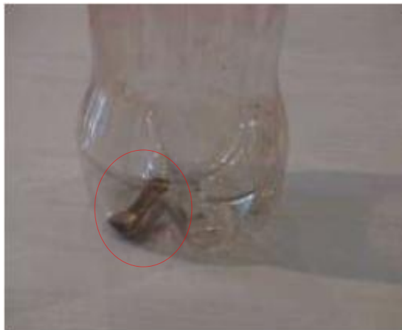
Figura 3-3: Defecto Visual – Contaminación.
