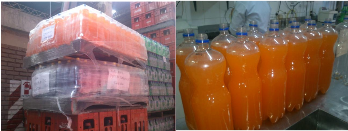
Figura 3-14: Muestras para Realizar la Prueba de Retención de Carbonatación.
