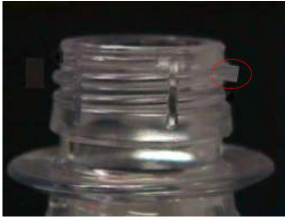
Figura 3-5: Defecto Visual – Rosca Mal Formada.
