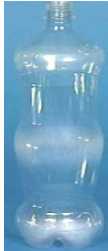
Figura 3-7: Defecto Visual – Perlescencia.
