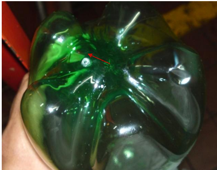
Figura 3-9: Punto de Inyección Descentrado.
