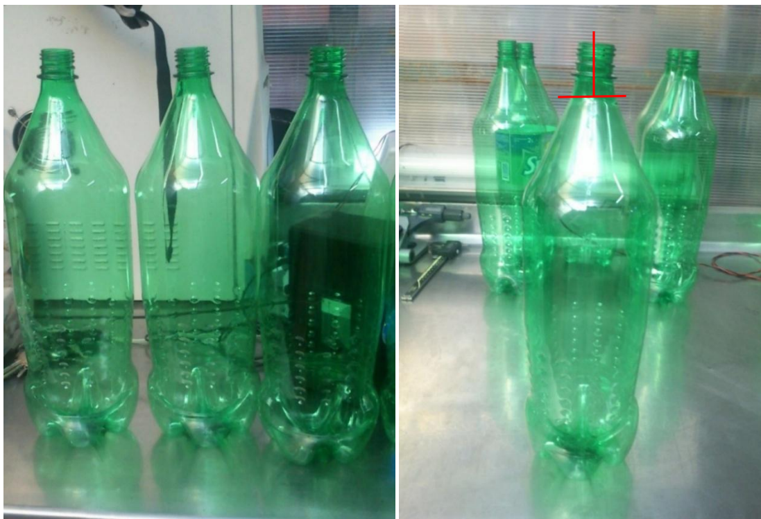
Figura 3-4: Defecto Visual – Fuera de Perpendicularidad.
