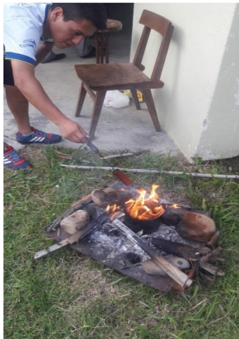
“Parafinado de las probetas para sacar el volumen por inmersión”
