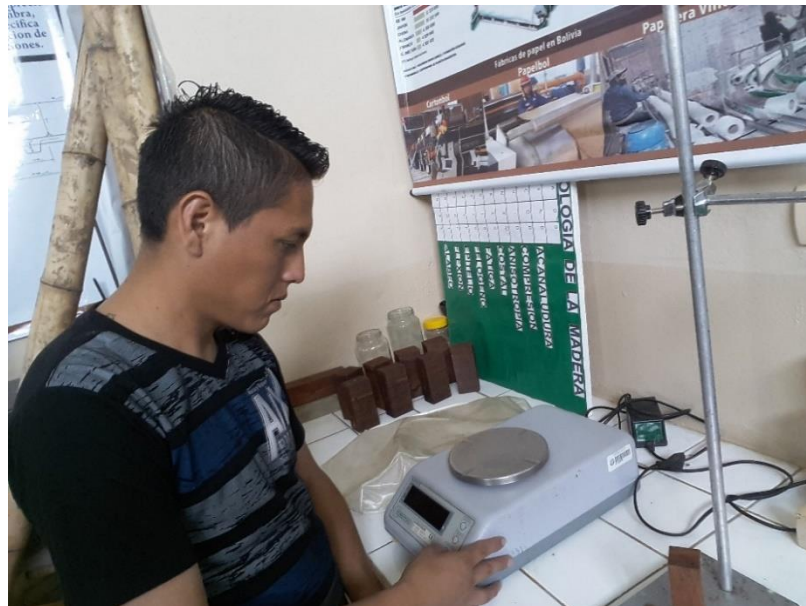
“Pesando las probetas en la balanza de precisión”
