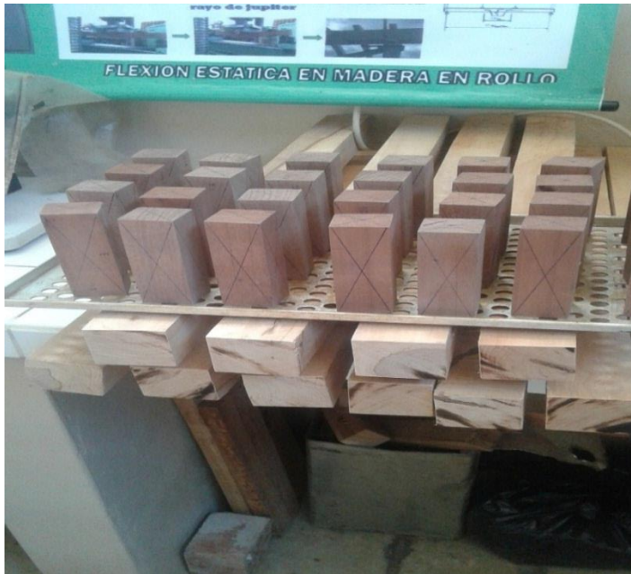
Probetas sacadas de la estufa para ser pesadas en la balanza.
