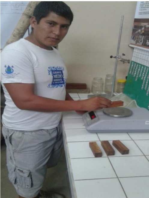
Pesando las probetas seco al aire en la balanza de precisión.
