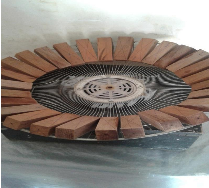
Probetas en proceso de secado al aire
