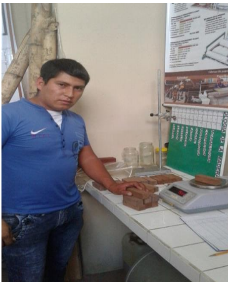
Pesado de las probetas en estado anhidra
