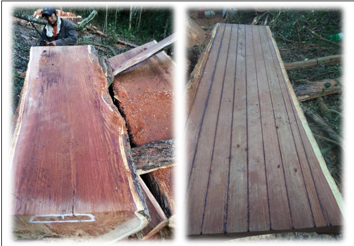
Fot. D-6. Preparación de las secciones (mitades) de las trozas para el aserrado
