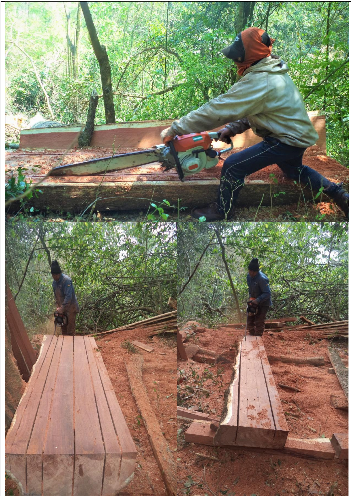
Fot. D-8. Aserrado de las secciones de las trozas con motosierra.
