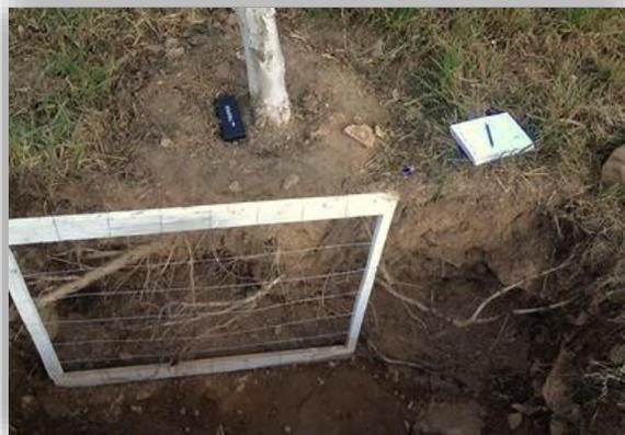
*Imagen N°13 Excavación para el análisis de raíz*
