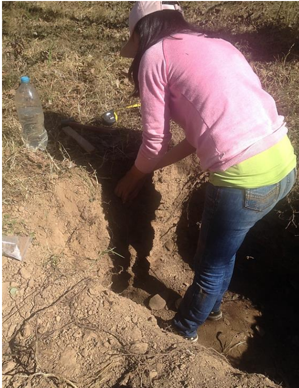
FOTOGRAFIAS N° 10 Recolección de muestras para el estudio de propiedades físicas-químicas de los 5 sitios y almacenados en bolsa de polietileno
