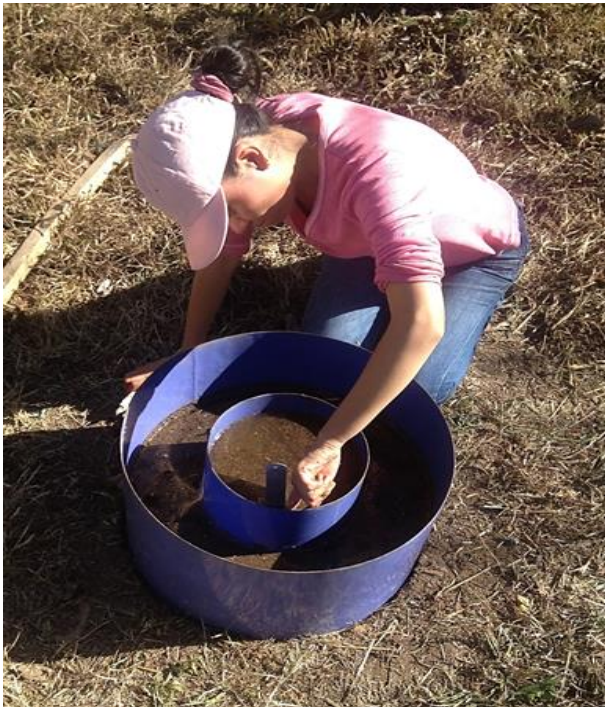
FOTOGRAFIAS N°4 Lectura de la velocidad de infiltración en cada uno de los sitios
