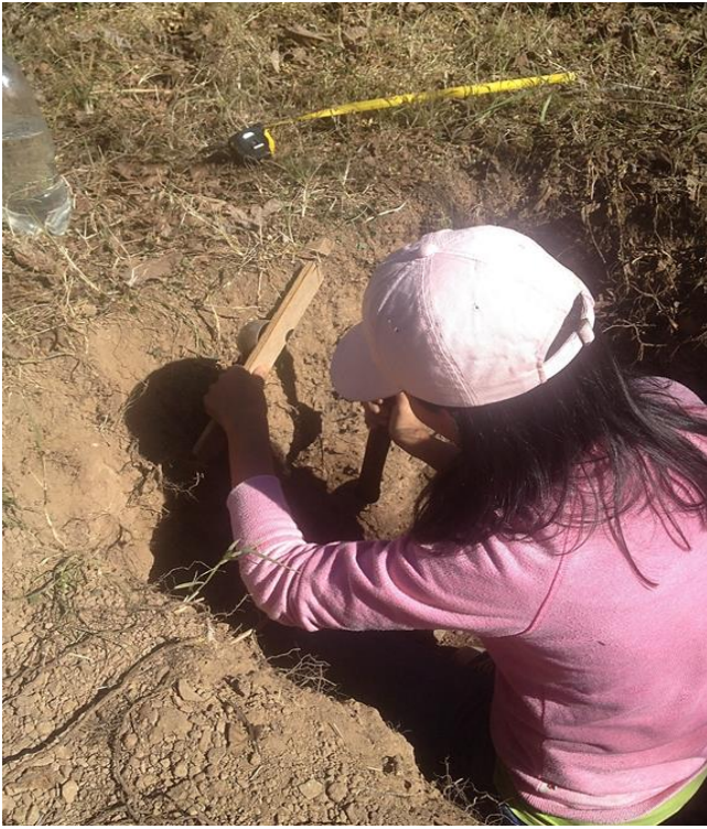
FOTOGRAFIAS N° 9 Toma de datos de muestras con el cilindro para el estudio de densidad aparente
