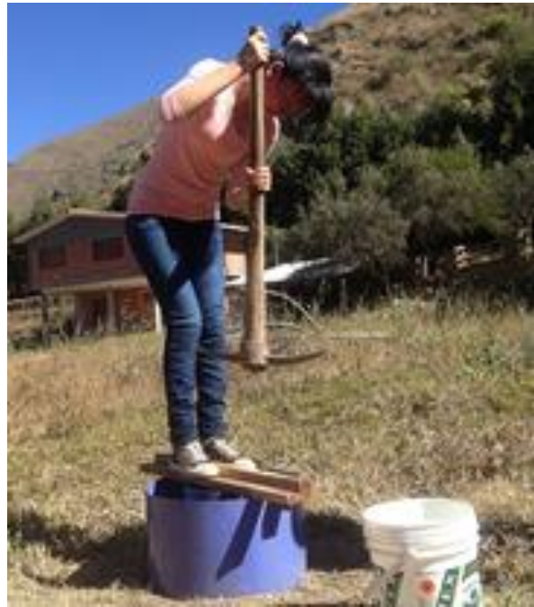
FOTOGRAFIAS N° 2 Preparación para el estudio por el método de doble anillo
