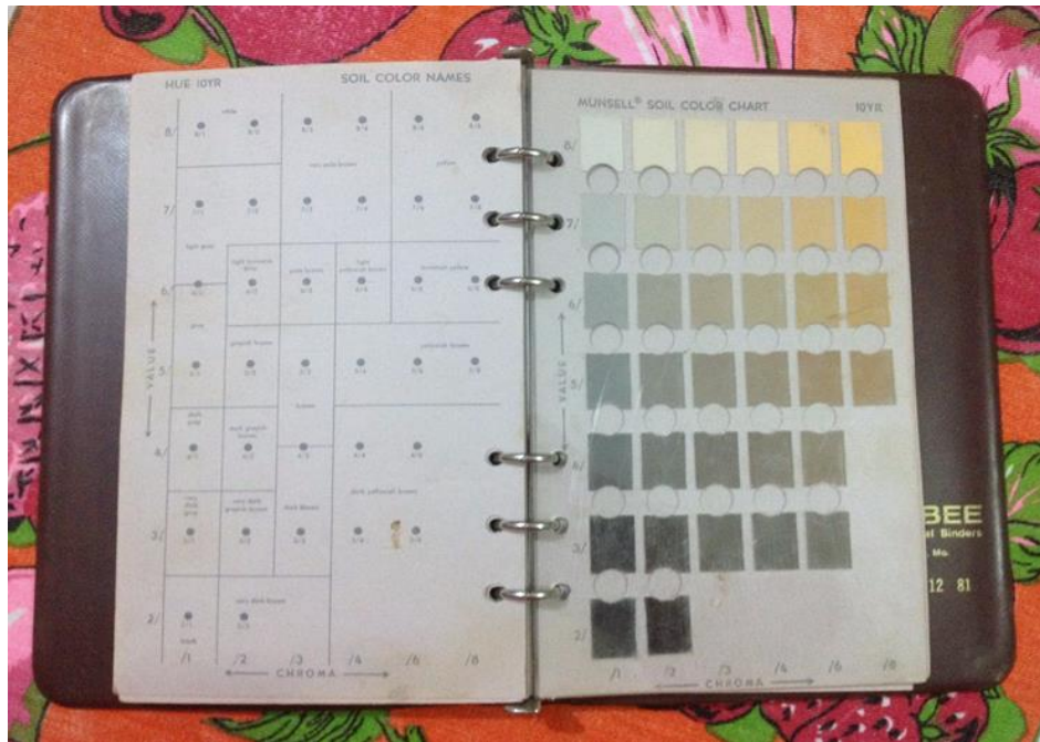
FOTOGRAFIA N° 8 Tabla Munsell, utilizada para la descripción de perfiles de suelo en los 5 sitios
