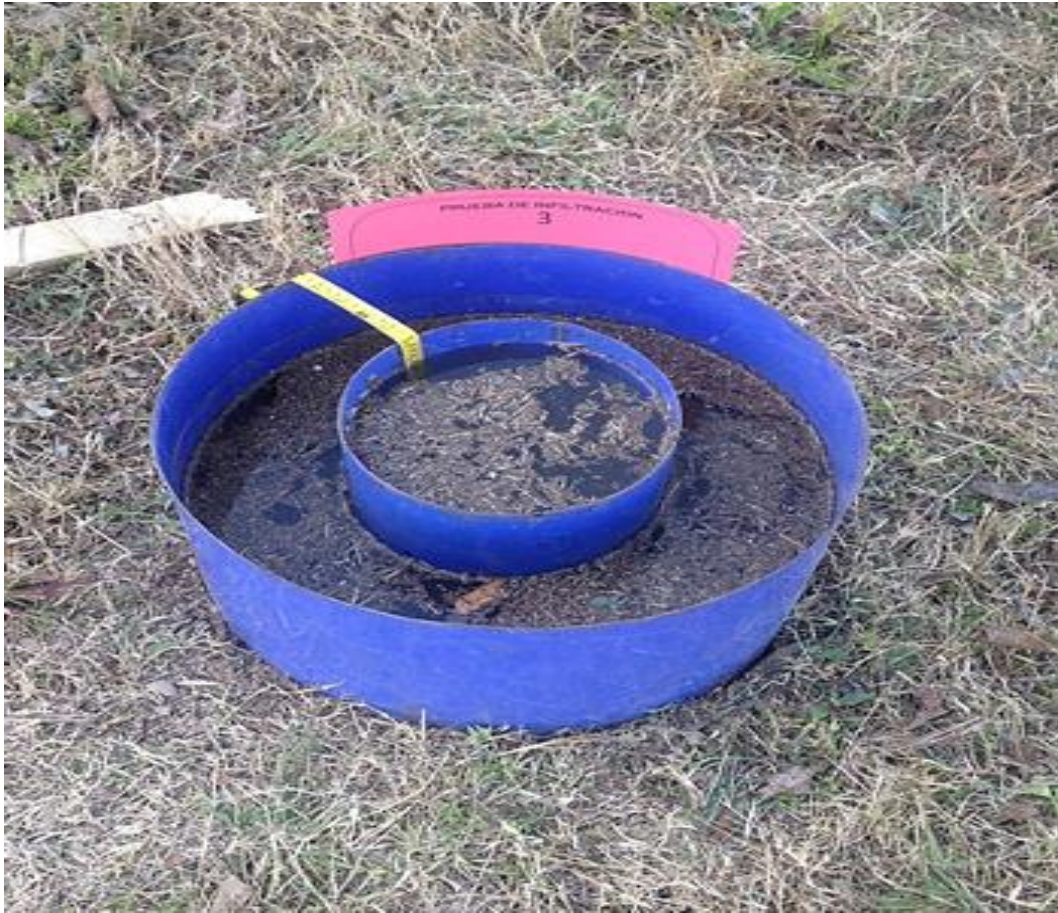
FOTOGRAFIA N°3 Infiltración del sitio 3
