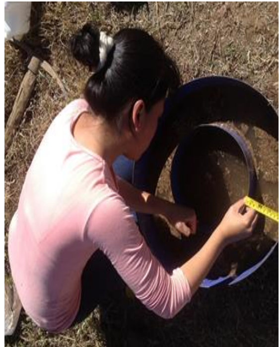
FOTOGRAFIAS N°4 Lectura de la velocidad de infiltración en cada uno de los sitios
