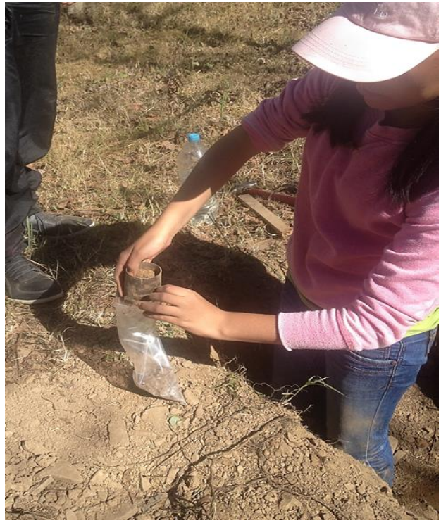
FOTOGRAFIAS N° 9 Toma de datos de muestras con el cilindro para el estudio de densidad aparente
