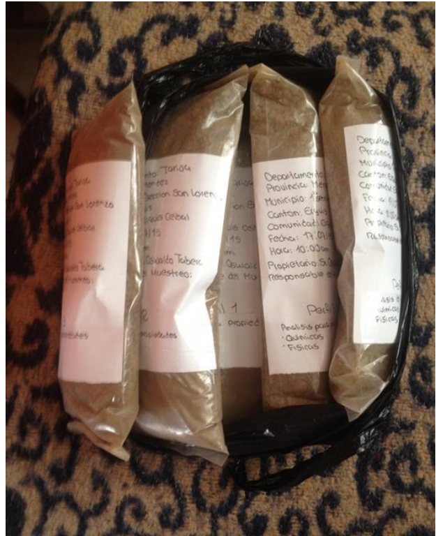
FOTOGRAFIAS N° 10 Recolección de muestras para el estudio de propiedades físicas-químicas de los 5 sitios y almacenados en bolsa de polietileno
