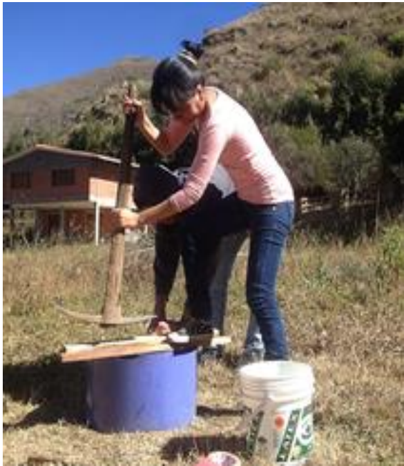
FOTOGRAFIAS N° 2 Preparación para el estudio por el método de doble anillo
