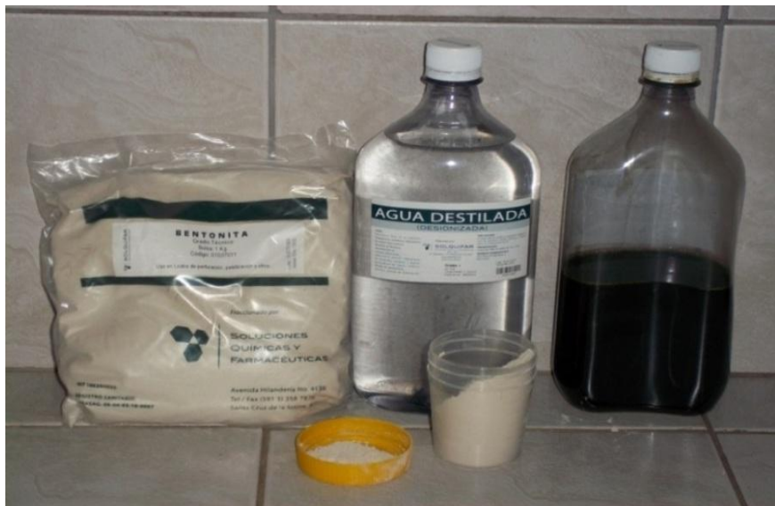
Fig 2-14 (reactivos para el ensayo de clarificación con bentonita sódica con agua)
