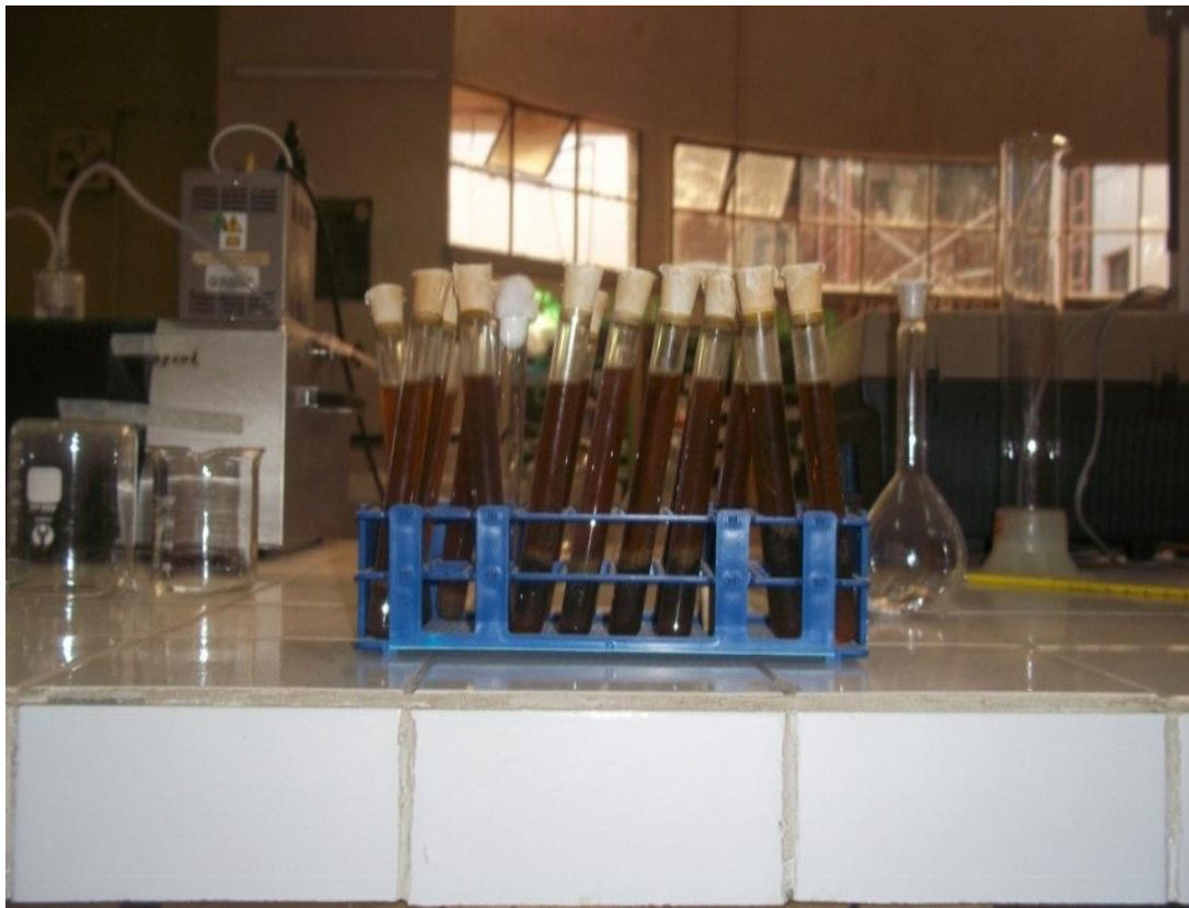
Fig. 2-11 (Extracto con agente clarificantes bentonita sódica y ácido cítrico anhidro después de varios días de reposo)
