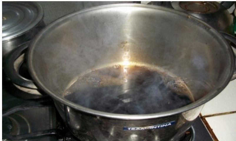
Fig 2-21 (evaporación de extracto clarificado y desodorizado con y sin filtración con diatomeas)
