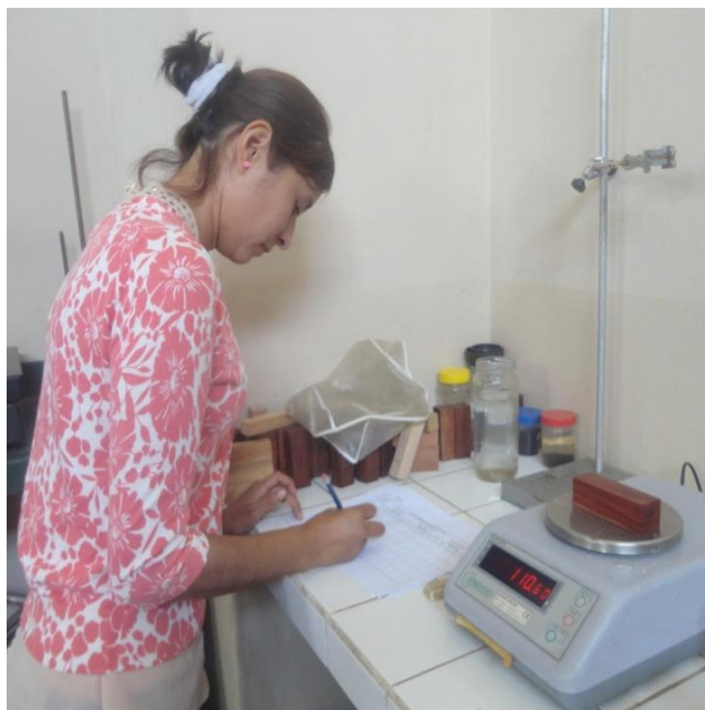
“Pesando las probetas en la balanza de precisión”
