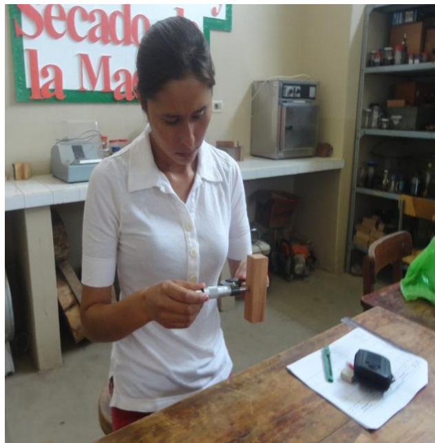
“Medición de las probetas cara radial, tangencial”
