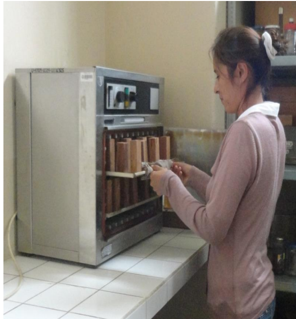
“Colocado de las probetas a la estufa”
