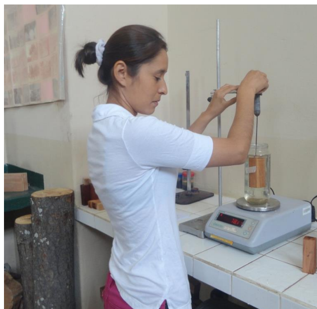
“Introducción de la probeta al cubo de agua para calcular el Volumen
