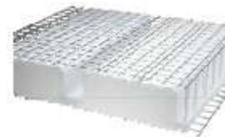
El refuerzo de acero se integra con el panel durante el montaje insertando las barras adicionales – determinadas según cálculo – dentro las ranuras del panel.
