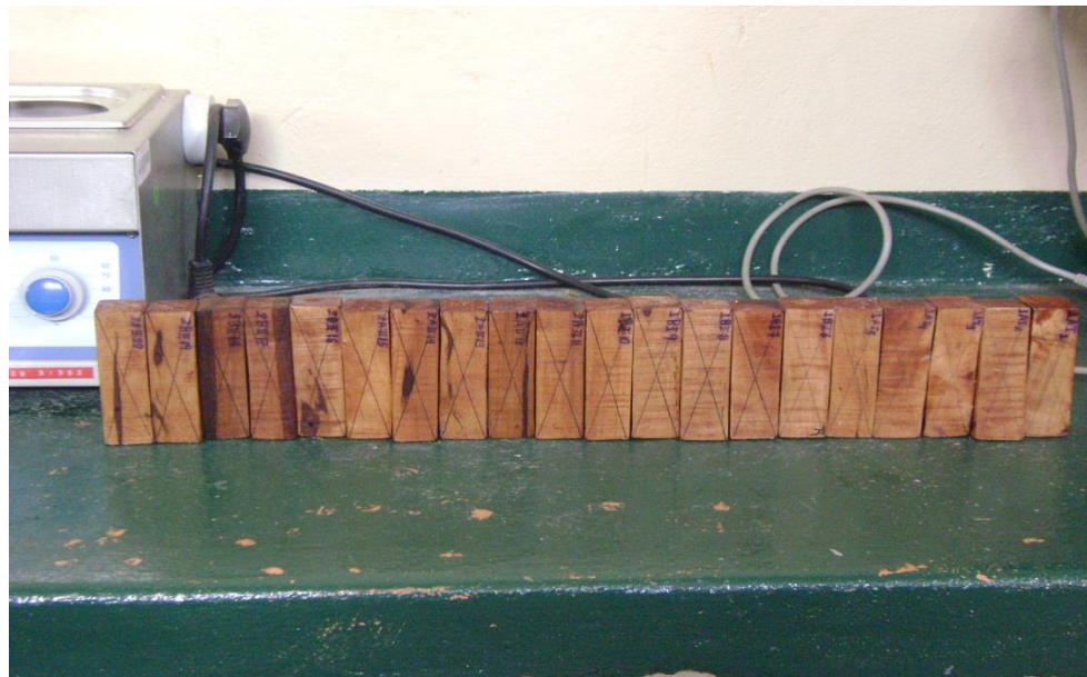
FOTO N° 7 Parafinando las probetas
