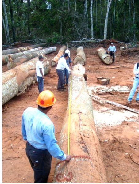
Foto N° 3.- Medición del largo de las trozas en rodeo
