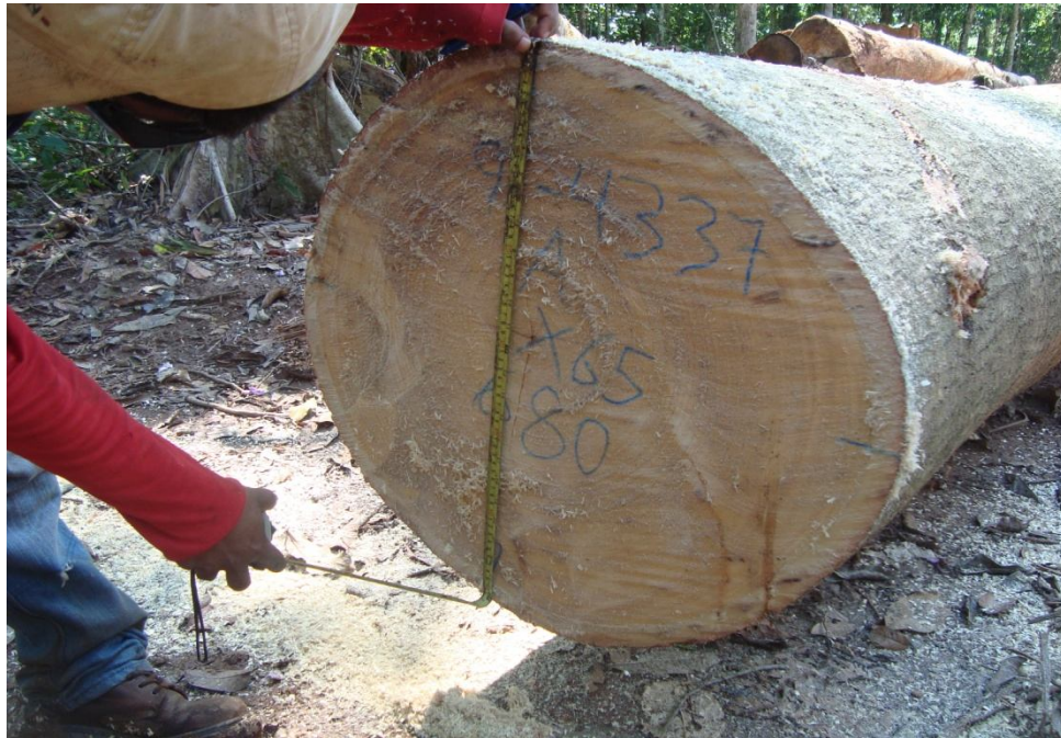
Foto N° 4.- Medición del diámetro y registro de información de la troza en rodeo
