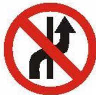
SR-14: PROHIBIDO CAMBIO DE CARRIL
