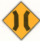
SP-36: PUENTE ANGOSTO
