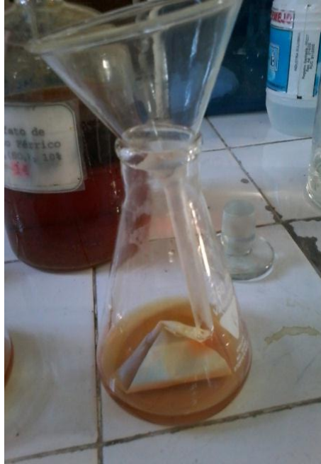
Figura 2-14 Disolución de óxido cuproso en sulfato de amonio férrico
