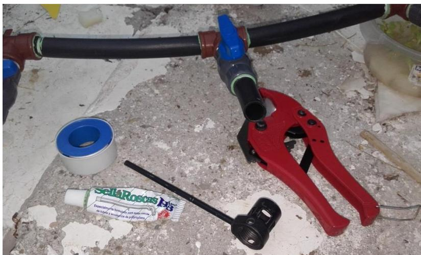
*Figura N°15. Equipo para el armado de tuberías de entrada y salida*
