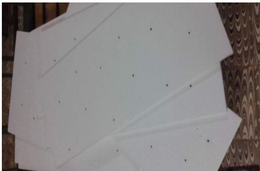
*Figura N° 6. Marcado de los orificios al plastaformo*
