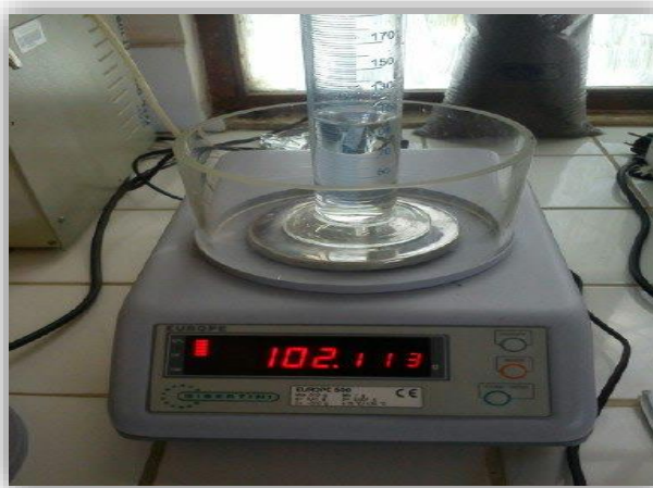
Figura 2.24. Determinación de la Densidad (Peso de 100 ml de ácido sulfúrico 4%).
