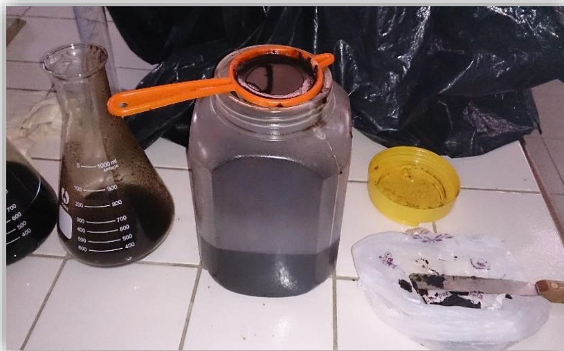
Figura 2.27. Filtrado y Eliminación de Partículas del Sustrato
