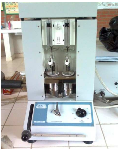
Figura 2-11 Extractor por solvente tipo Soxhlet, Selecta.
