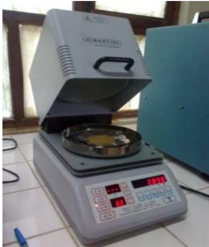
Figura 2-8 Balanza de humedad Eurotherm
