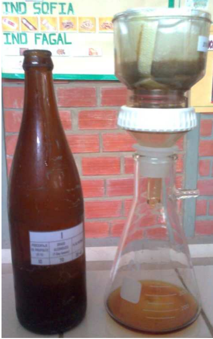
Figura 2-14 Filtrado al vacío de Tintura madre de propóleos
