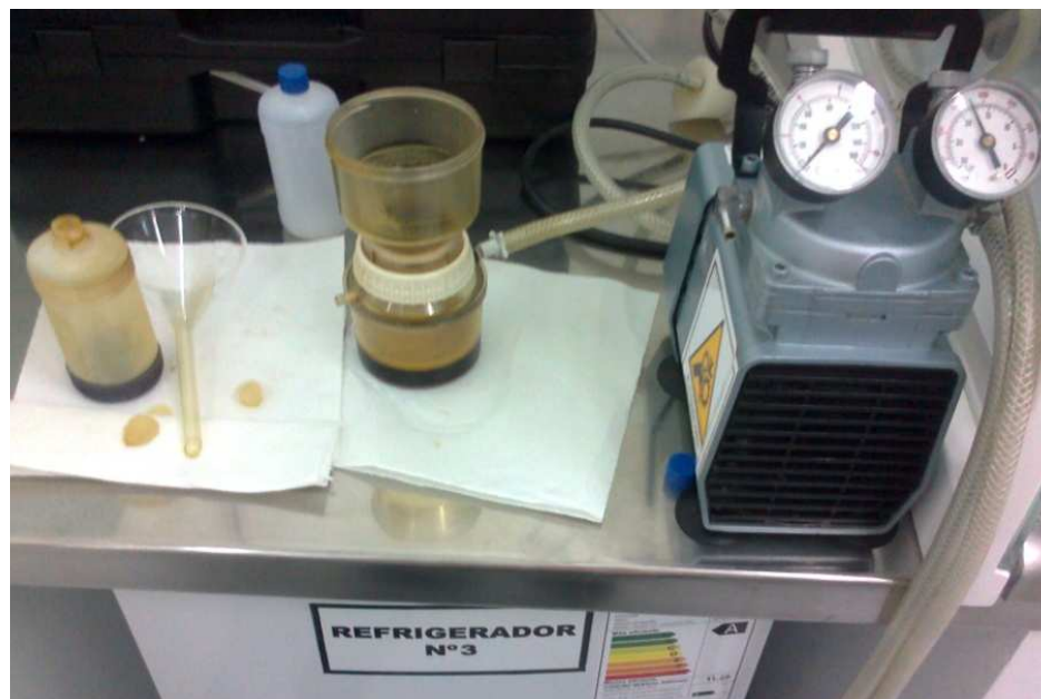
Figura 2-18 Filtrado al vacío para la extracción de ceras
