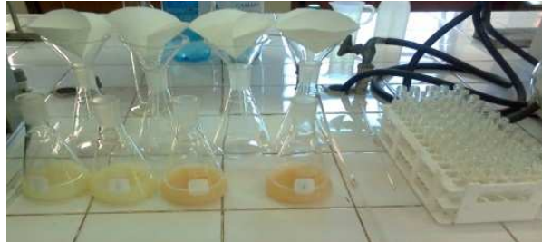
Figura 2-18 Material y uno de los ensayos en proceso, para la determinación del índice de oxidación
