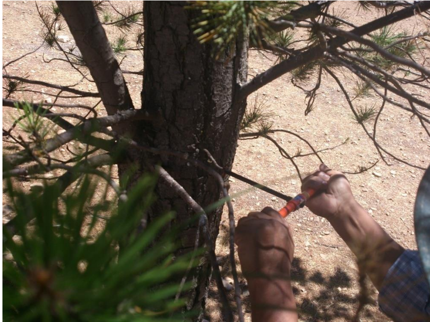
Extracción de cilindros de madera con el barreno de Pressler
