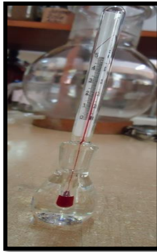
Figura 3-24: Picnómetro de vidrio con termómetro
