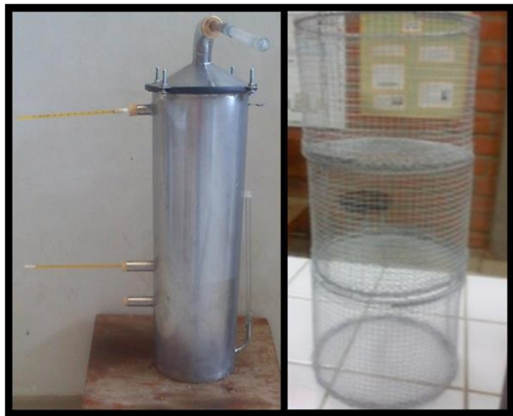
Figura 3-15: Cámara de extracción del LOU con sus tres canastillos interiores
