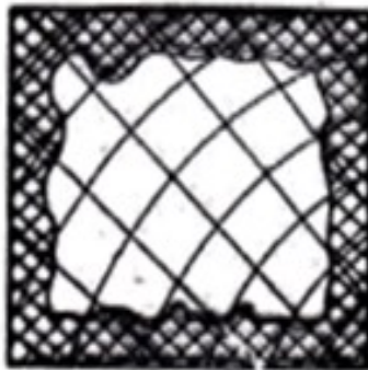
4. Parcial regular: cuando la zona penetrada es periférica y más o menos uniforme.
