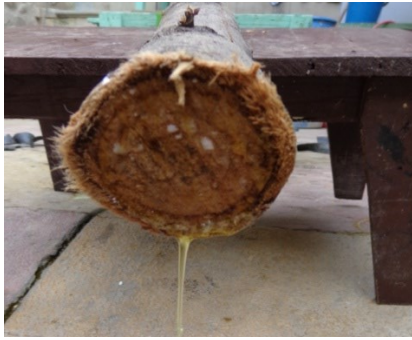
Expulsión de savia junto al preservante
