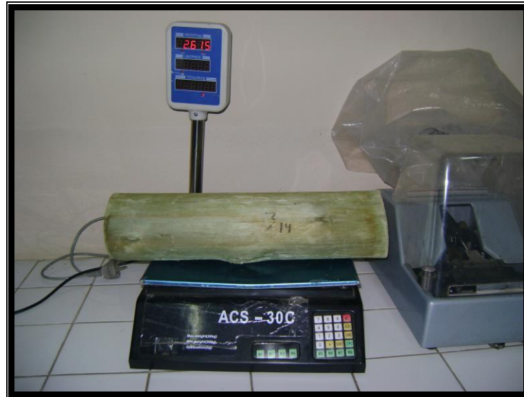
FOTO N° 3 Pesado de las Probetas en la Balanza ACS-30 C con 0,5 gr. de precisión.
