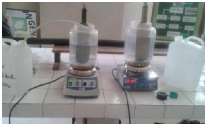
Figura 2-6 Enfriamiento de vino con baño de refrigerante y agitación magnética
