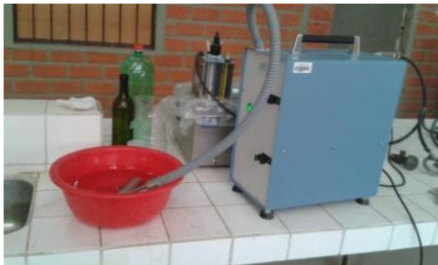
Figura 2-7 Equipo utilizado para enfriar el refrigerante utilizado en la simulación experimental
