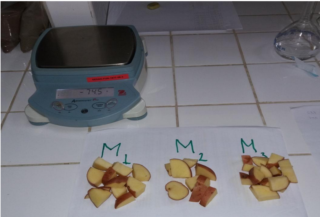
Foto 20. tres muestra de tuberculo ya preparadas para determinar el porcentaje de materia seca
