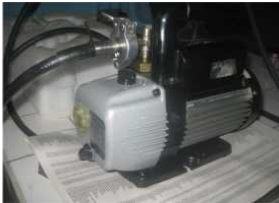
Figura 2-2.- Bomba de vacío
