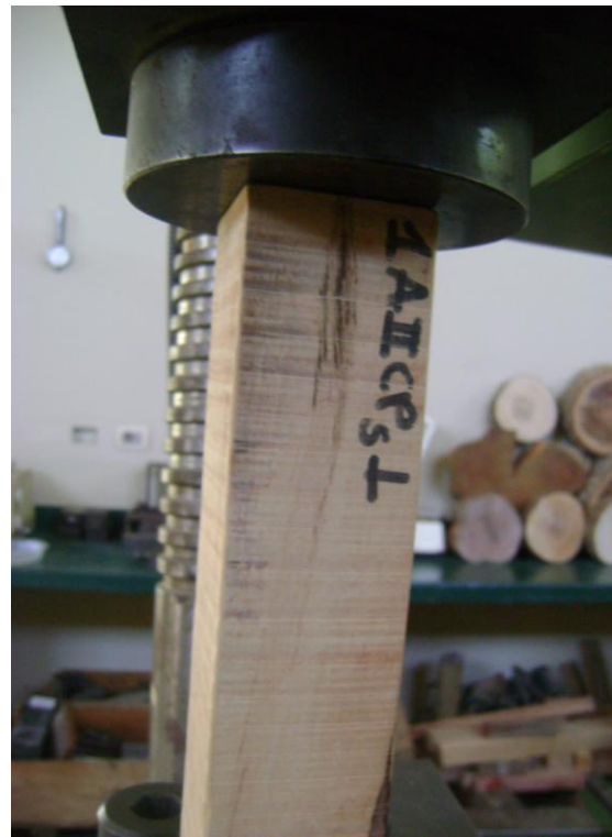
Foto 4: Ensayo de Compresión Paralela
