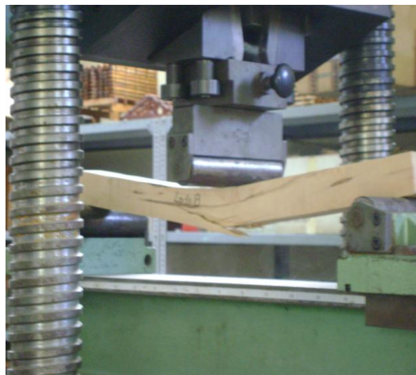
Foto 2: Ensayo de Flexión Estática
