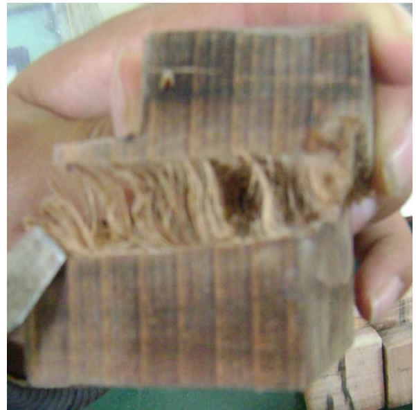
Foto 10: Ensayo de Cizallamiento, Corte producido en las Fibras
