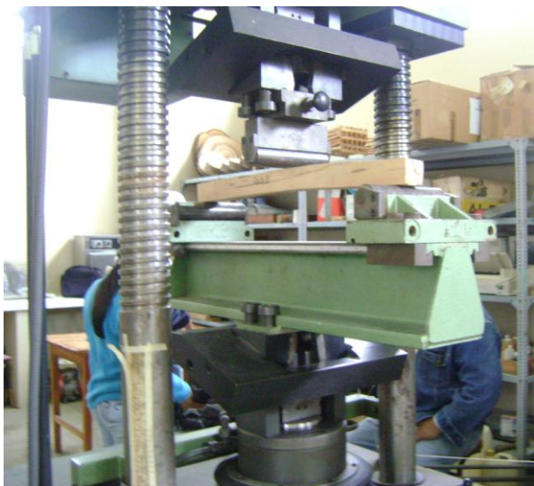
Foto 2: Ensayo de Flexión Estática
