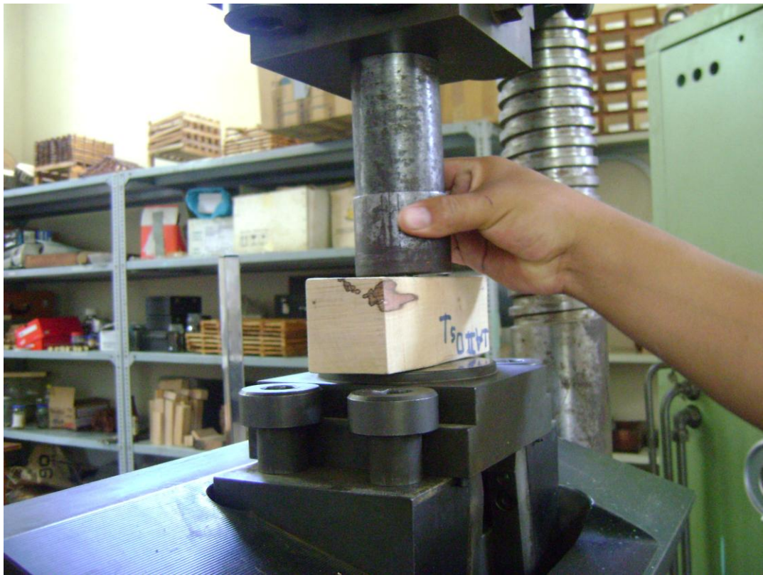
Foto 8: Ensayo de Dureza
