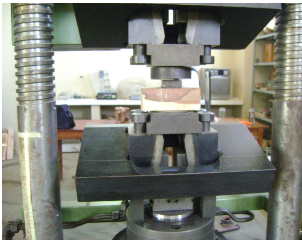
Foto 6: Ensayo de Compresión Perpendicular
