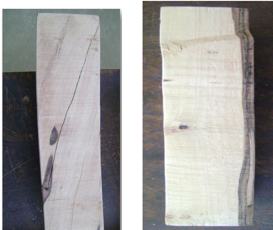
Foto 5: Fallas obtenidas en el ensayo, Cizallamiento y Aplastamiento
