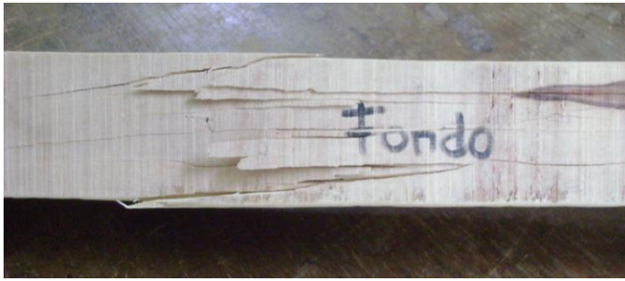
Foto 3: Fallas del ensayo, Tracción Simple
