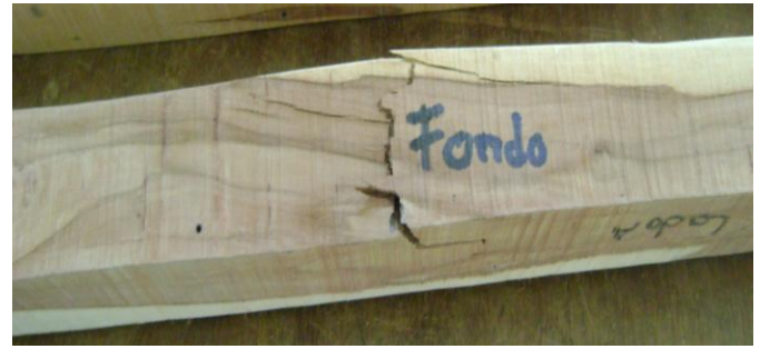
Foto 3: Fallas del ensayo, Tracción Simple
