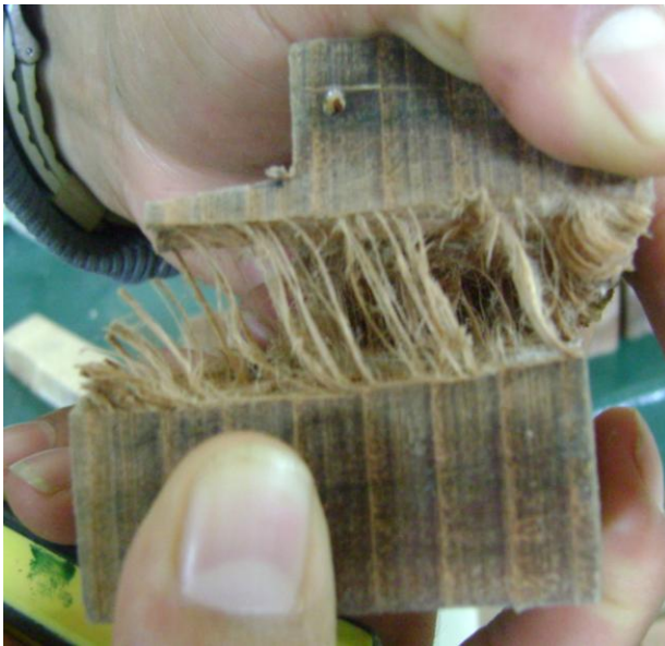
Foto 10: Ensayo de Cizallamiento, Corte producido en las Fibras
